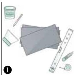
**(1) Werkzeuge:** Bleistift, Maßband, Wasserwaage, Richtschnur, Cuttermesser, MultiConnect-Fliesenkleber, Zahnpachtel, Abschlussprofil
