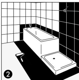
**(2) Tragfähiger Untergrund:** dauertrocken, sauber, frei von Staub, Öl und Fett, von losen Teilen und nicht wasserfesten Altanstrichen sowie hinreichend ebenflächig und biegesteif. Dichtanstrich, ggf. mit Dichtband, in Nassräumen und bei feuchtigkeitsempfindlichen Untergründen.
